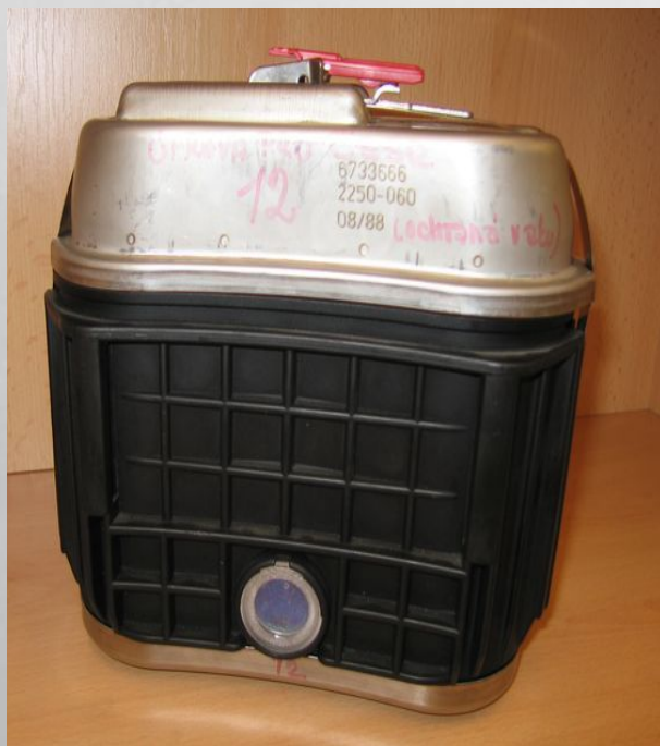
OXYBOKS K přenášení na opasku, váha: 2,1 kg
