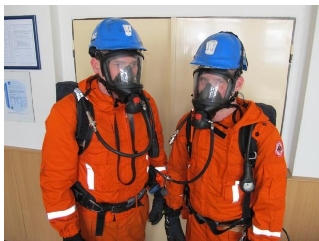
Dýchání dvou uživatelů z jednoho přístroje.
