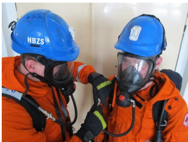
Odpojení přívodní hadice plicní automatiky nefunkčního přístroje.
